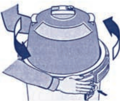
Abbildung 4: Lasche eindrücken zum Öffnen des Gewindinges.
